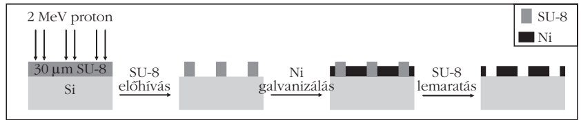
2. ábra. A mikromegmunkálás folyamata
