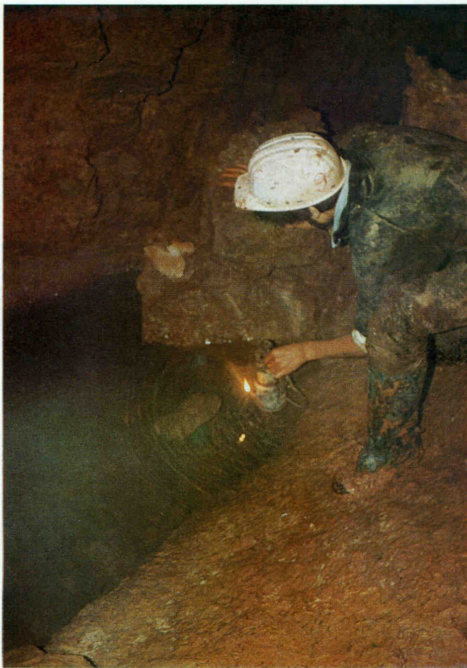
Barlangi levegő radontartalmának mérése szilárdtest nyomdetektorral
