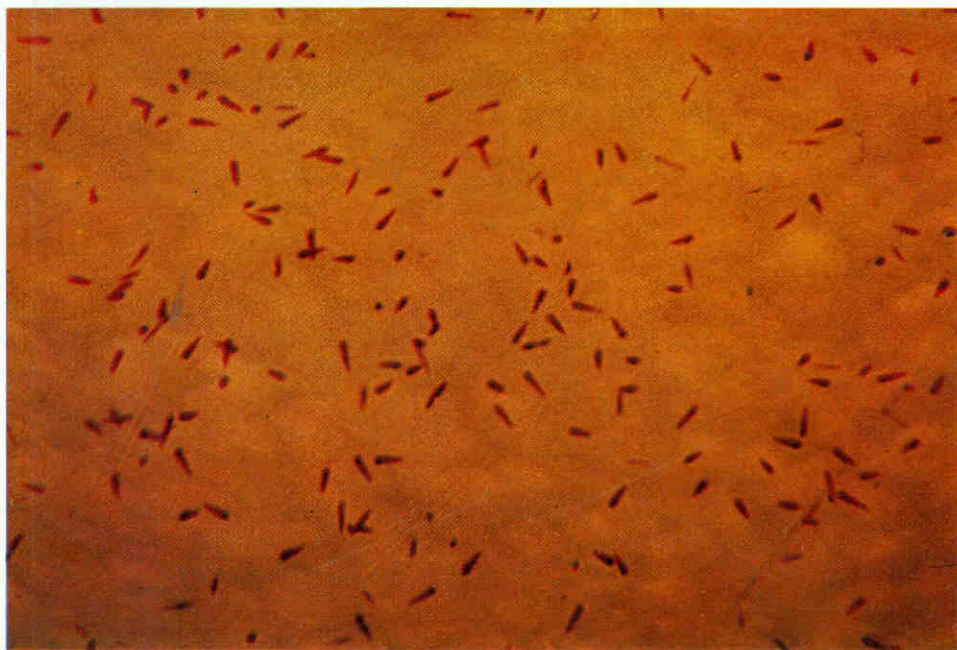
Alfa-részek nyomai szilárdtest nyomdetektorban. A nyomok láthatóvá tétele egy az ATOMKI-ban kidolgozott új eljárással történt.
